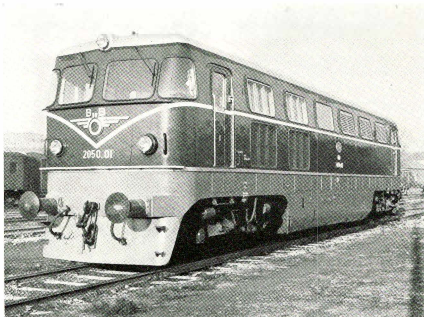
Fire-akslet diesellokomotiv til hurtigtog (12 cylindret 2-takts dieselmotor på 1425 hk) egenvægt 72 tons.
